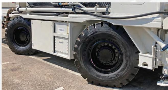
ベースマシンには国交省指定第 3 次基準値排出ガス対策型エンジン C7-IPSJ を搭載しています。全輪駆動にてスピーディーかつパワフルな走行性能を発揮します。
